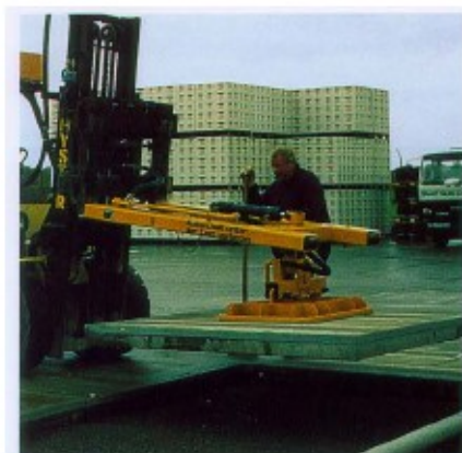
Układanie płyt za pomocą wózka widłowego z zainstalowanym chwytakiem próżniowym.
